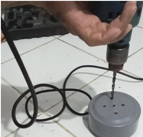
(b) Pembuatan Lubang Dot Menggunakan Alat Bor
