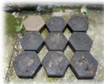
Gambar 3. Sampel paving blok hasil pengolahan sampah.
